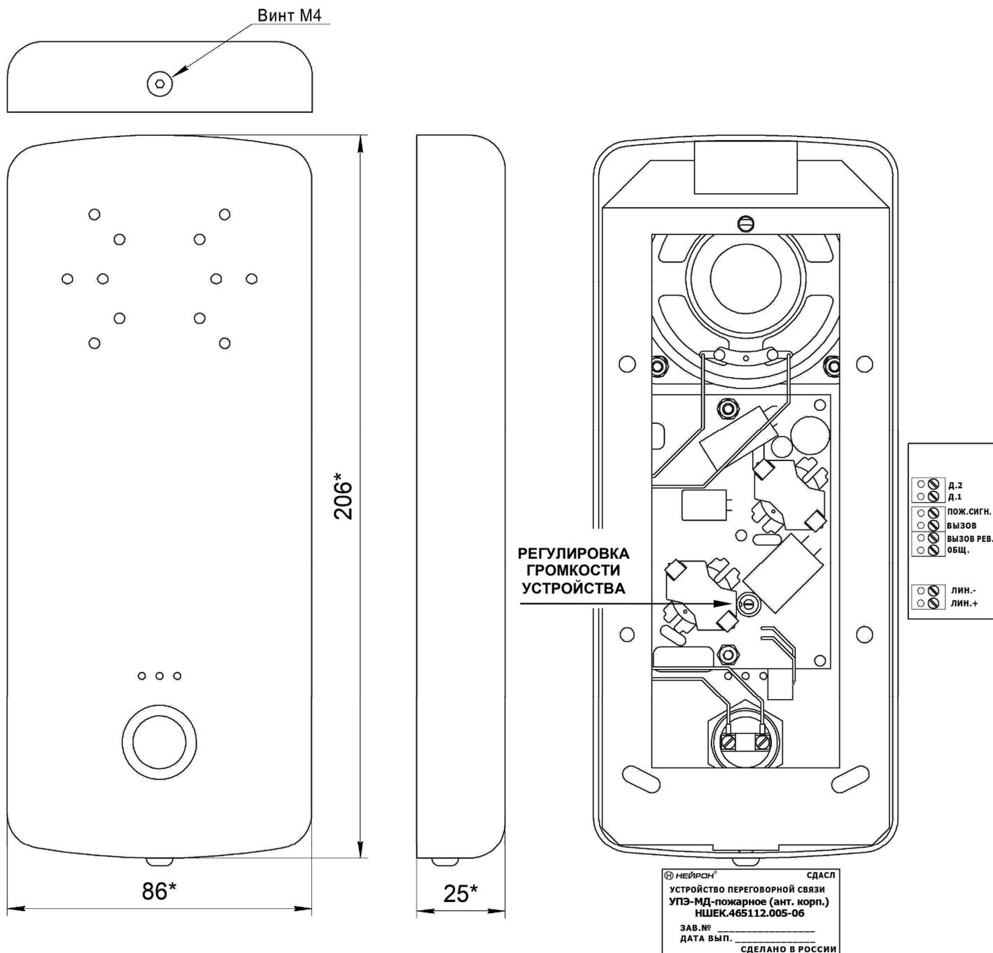
Рис.2 – Внешний вид устройства переговорной связи «УПЭ-МД-пожарное (ант. корп.)»
